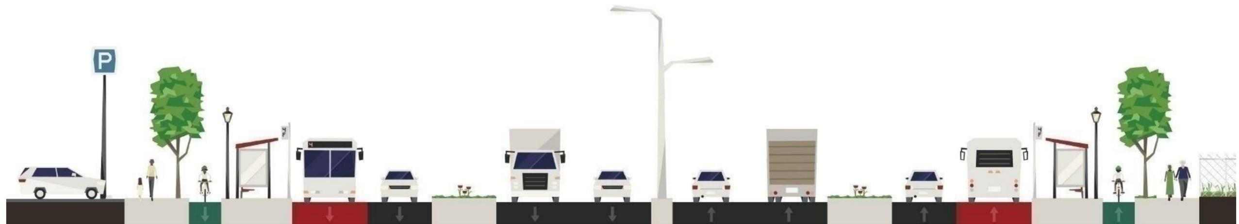
Figura 9: Modelo Geral de via Estrutural - BR 364, pistas centrais com operação de via de Trânsito Rápido e marginais como via arteriais.
